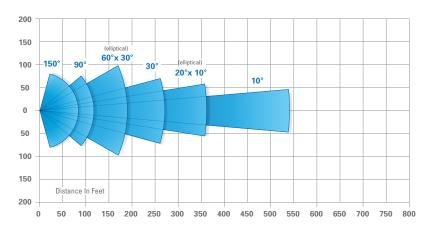
Angle: **150°** Range: 80ft /24m HFOV: 155ft /47m Angle: **90°** Range: 120ft /36m HFOV: 152ft /46m Angle: **60°x 30°** Range: 190ft /58m HFOV: 190ft /58m Angle: 30° Range: 270ft /82m HFOV: 140ft /42m Angle: **20°x 10°** Range: 360ft /109m HFOV : 112ft /34m Angle: 10° Range: 540ft /164m HFOV : 94ft /28m
